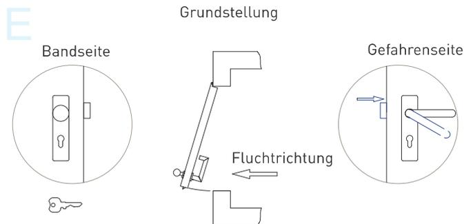
\* Eine Öffnung von der Gefahrenseite ist in allen Funktionen immer möglich. Schlösser nach DIN EN 170 mit Umschaltfunktion sind sowohl in Fluchrichtung (auswärts), als auch gegen die Fluchrichtung (Gefahrenseite gleich Bandseite) öffnend erhältlich. **Die Öffnungsrichtung muss bei der Schlossbestellung angegeben werden.** Für weitere Sonderfunktionen sprechen Sie bitte Ihren interkey-Fachhändler an.
